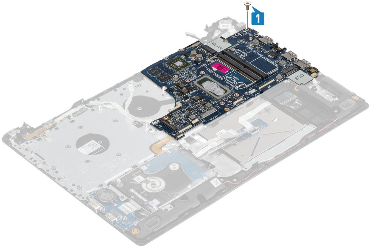
6. Collocare il connettore dell'unità ottica e ricollocare la singola vite (M2x2) che lo fissa alla scheda di sistema [1, 2].
